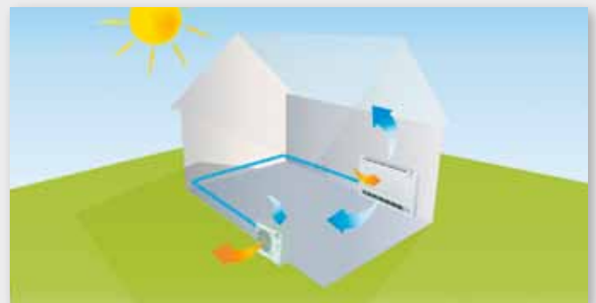
Im Sommer wird die Wärme aus dem Inneren nach außen abgegeben (nur bei Yutaki S möglich).
